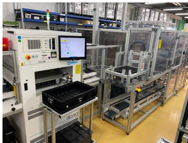
Slika 6: Avtomatiziran ICT testni sistem SPEA v robotizirani celici
